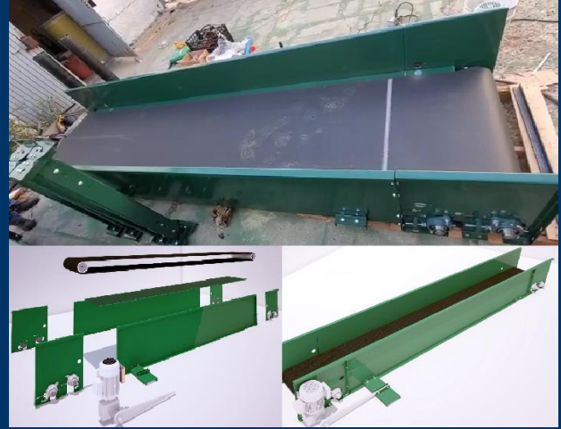
Diseño y fabricación de Conveyor para el aeropuerto de Cancún terminal dos
