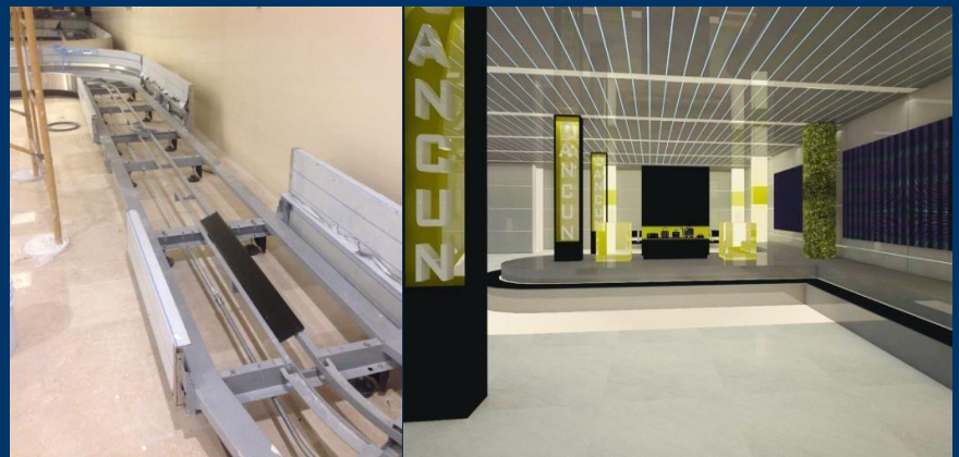
Diseño y fabricación de Conveyor para el área de recolección de maletas para el aeropuerto de Cancún terminal tres
